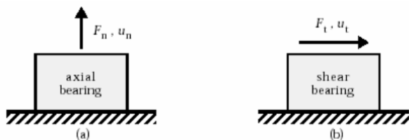
Hình 3. Gói đỡ LRBs chịu lực dọc trục (a) và chịu cắt (b)
